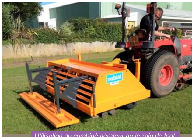
Utilisation du combiné aérateur au terrain de foot.
